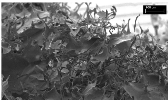
Figura 3: Micrografía tomada mediante microscopía electrónica de barrido (SEM) al sistema con una proporción 0:100 de gelatina/quitosano (G/Q) elaborada mediante el protocolo estándar (método A).
