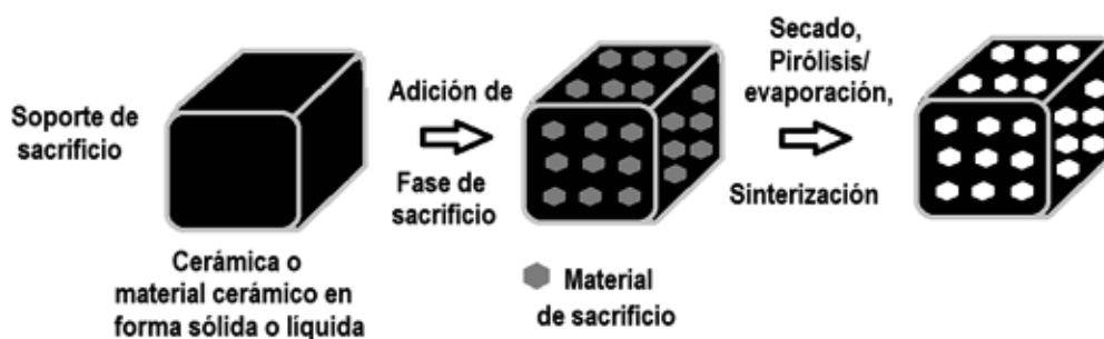
Figura 1. Esquema de síntesis de la espuma que se utiliza como soporte.
