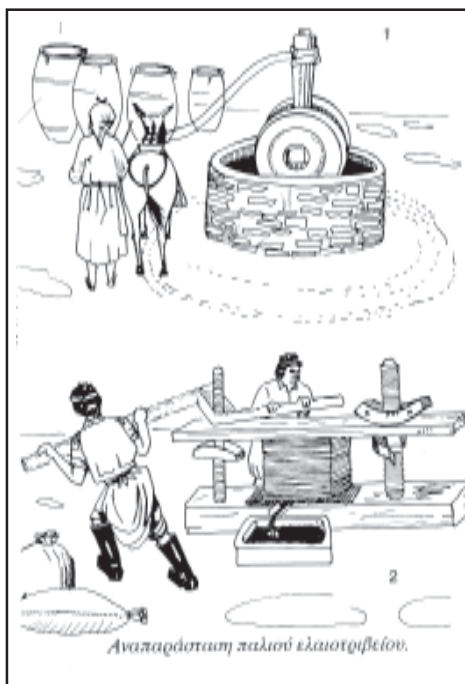
Figura 7 Reconstrucció d'un antic molí d'oli de Creta
