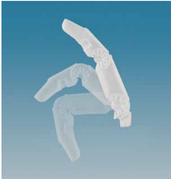
▲ Figura 15. Sección de un dedo que muestra el diseño de las articulaciones, fabricado en una sola pieza gracias a la fabricación aditiva por sinterizado láser. Fotografía proporcionada por kiwibravo.
