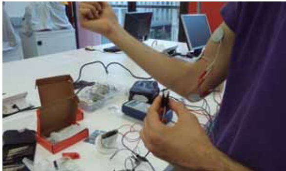
▼ Figura 16. Control del motor servo que genera el movimiento de un dedo a partir de las señales electromiográficas producidas en la contracción y relajación de un músculo.
