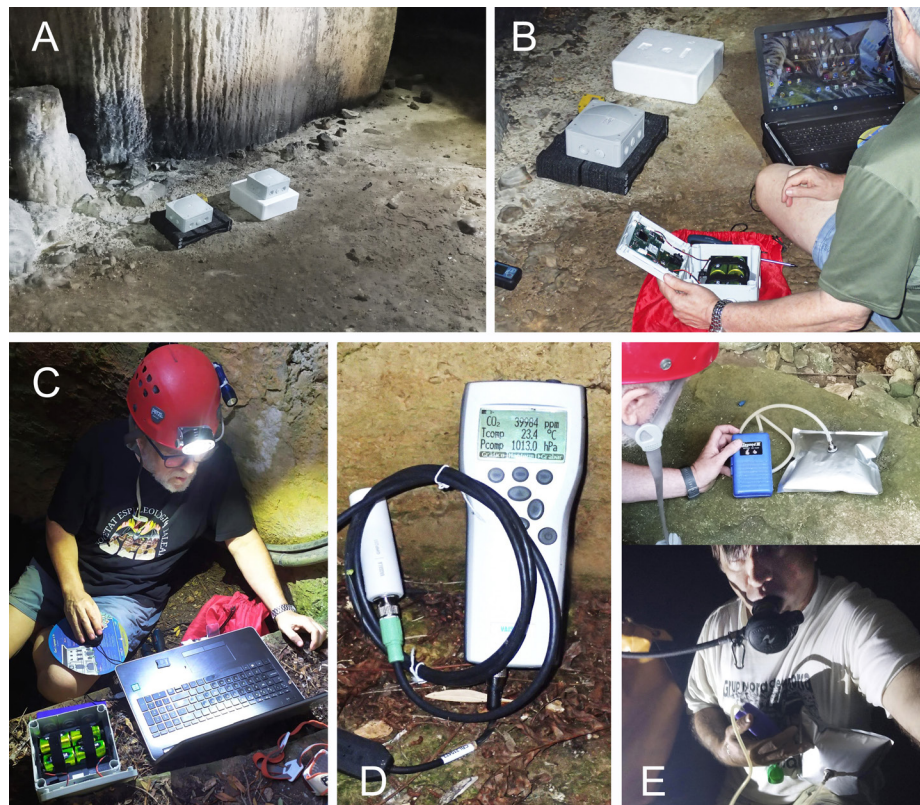
Figura 6: Equipament utilitzat en la campanya de l'any 2023. A: Ubicació dels data-loggers en un lateral del replà on estava situada l'estació 7 (vegeu Figura 2). B: Comprovant el funcionament durant la instal·lació dels dispositius. C: Descàrrega de les dades i canvi de les bateries a la zona d'entrada de la cavitat. D: Dispositiu mesurador de la firma Vaisala , amb un rang de mesura fins a 200.000 ppm de CO 2 . E: S'han utilitzat bosses tipus Ritter per als mostres d'aire de la cova, essent necessari l'ús d'equips autònoms de respiració per a les incursions realitzades durant la temporada estival.
