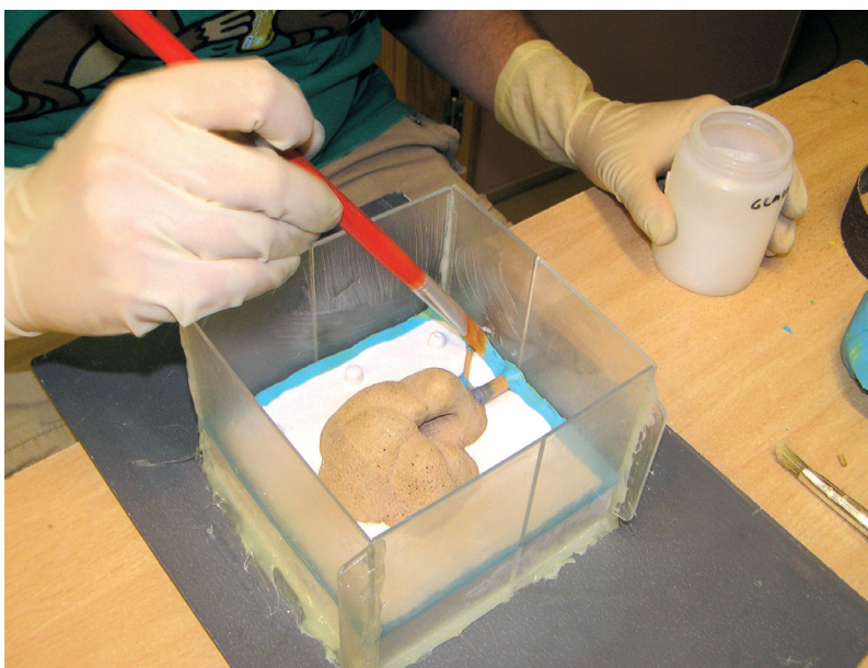
Fig. 6. Detalle del encofrado para el vertido de silicona durante la aplicación de desmoldeante. El foraminífero a replicar es la pieza tallada en barro cocido.
