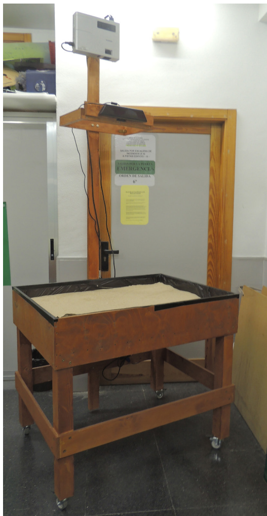
Fig. 2. Resultado final de la caja de arena construida.
