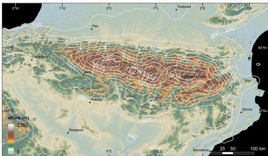
Fig. 1. Imagen de la topografía de los Pirineos a partir de un modelo digital del terreno (SRTM90) de resolución 90 m; la escala de color da la altura. Las líneas de contorno indican la altura media calculada alrededor de cada píxel y dentro de una celda de 30 km de diámetro, es decir a la misma escala que el espesor de la corteza.
