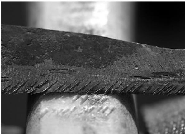
*Figura 17: Detalle del dentado del filo de una hoz. Puede verse claramente como cada diente provoca una incisión en el yunque de hueso.*
