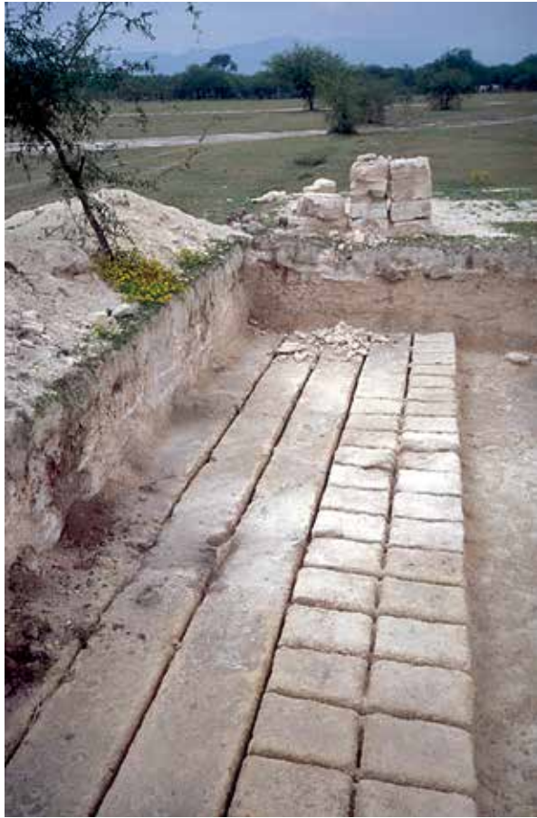
Figura 7. Extracció de guix d'un horitzó gypsic per a ser utilitzat en construcció de cases. San Luís Potosí, Mèxic (foto J. Porta).
