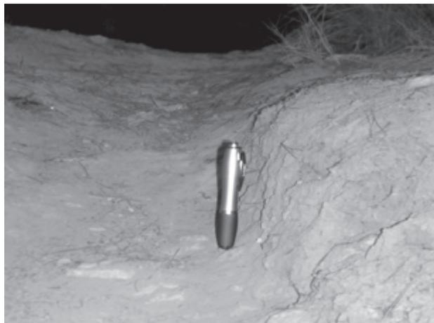
**Fotografía 4.** Detalle de la pérdida de suelo una vez iniciado el proceso de erosión. Suelo de tipo arcilloso
