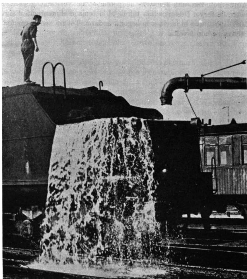
Un espectacle desaparegut: repostant aigua al dipòsit del tender de la màquina.
