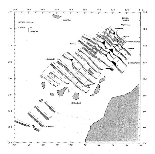
Figura 1.- Localización perfiles sísmicos de reflexión proyectados a lo largo de las líneas de navegación. Las zonas sombreadas indican profundidades inferiores a los 2500 m.
