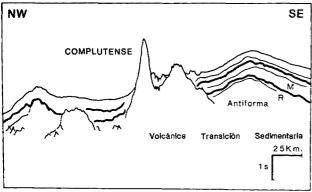
Figura 5.- Perfil sísmico que atraviesa las tres subzonas del área norte. Los reflectores marrón y rojo estan indicados por M y R.
