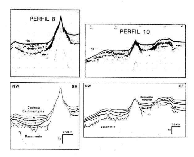
Figura 8.- Estos perfiles muestran la cuenca sedimentaria al NE del Banco Dacia, donde los reflectores M y R alcanzan unos máximos relativos de profundidad.
