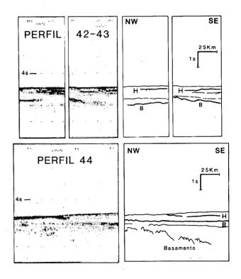
Figura 13.- Perfiles sísmicos de la zona meridional, situados al suroeste de Tenerife y Gran Canaria. El reflector B está definido como la cima de una capa volcánica miocena media, el reflector H es correlacionado con erupciones del sur de Gran Canaria.
