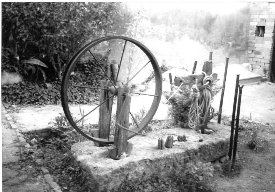
Una de les rodes de les Parellades que la família de Maria Solé encara conserva. Podem veure la pedra, la roda, la creu, els tascons, uns quants perpals, dues càbries i el ganxo. (Foto IEV)
