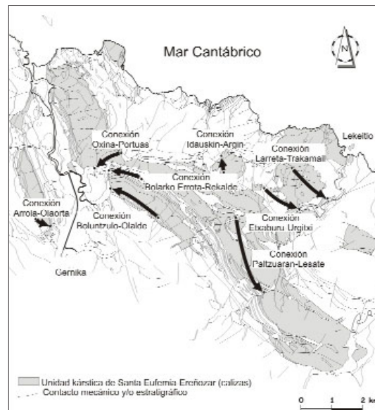
Fig. 5: Conexiones sumidero-surgencia en la Unidad Santa Eufemia-Ereñozar (Bizkaia) a partir de la interpretación de ensayos con trazadores (Fernández de Valderrama, 2004).
