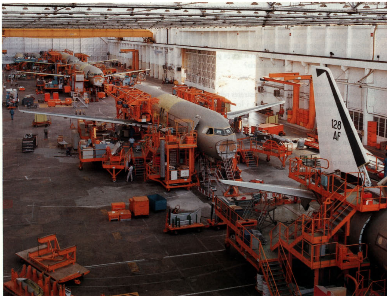
Cadena de muntatge de l'Airbus A320, fet per l'empresa Aérospatiale al municipi de Saint Martin, prop de Toulouse
