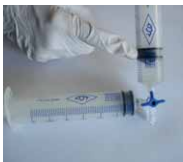
Figura 6. Muntatge per investigar la velocitat de dissolució del \text{CO}_2 en aigua.
