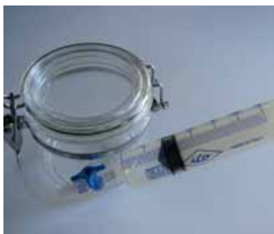
Figura 9. Pot de polimetil metacrilat amb una clau de tres vies per connectar-hi una xeringa.
