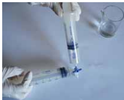
Figura 4. Detalls del procediment per a l'obtenció de \text{CO}_2 per reacció d'un carbonat amb un àcid.
