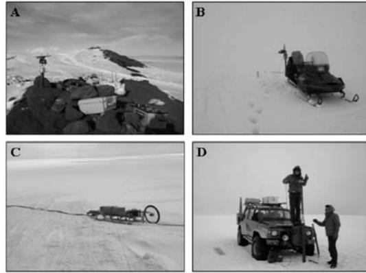
Fig. 6: Algunas de tareas de control del glaciar incluyen el establecimiento de bases GPS en el glaciar (A), la obtención de la topografía del glaciar mediante perfiles topográficos GPS (B), la obtención de datos de georadar (C), y la perforación de la capa superficial del hielo (D). (Fotografía A y B cortesía de Alexander H. Jarosch)
