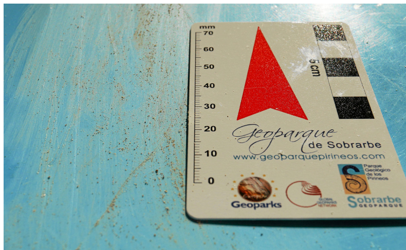
Fig. 9. Resultados obtenidos al frotar el hielo con sedimentos contra una superficie de plástico. Se aprecian las estrías subparalelas entre sí y a la dirección de transporte, así como restos de sedimentos finos sobre la superficie estriada.
