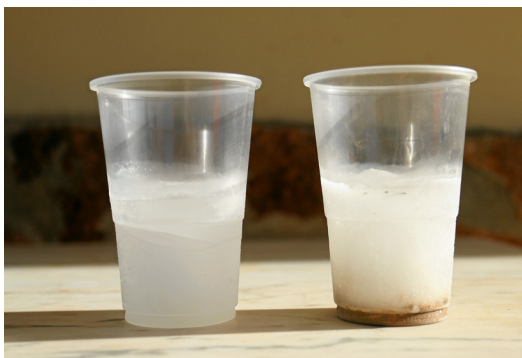
Fig. 8. Elementos necesarios para la simulación de la abrasión glaciar en laboratorio, hielo sin y con sedimentos.
