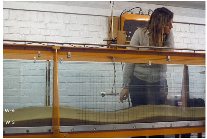
Fig. 15. En los estados de flujo de régimen alto, la superficie que separa el agua del sedimento y la superficie libre del fluido están en fase, como puede apreciarse en esta imagen obtenida en un canal de experimentación de la Universidad de Cambridge, Reino Unido. W-A: interfase agua-aire. W-S: interfase agua-sedimento.
