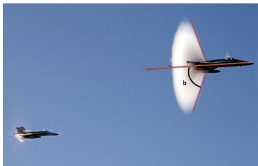
Fig. 12. ¿A qué velocidad va este avión? Si el ángulo fuera aproximadamente 30^\circ , \sin(30^\circ)=0.5 y por tanto, M=2 , este avión va al doble de la velocidad del sonido.
