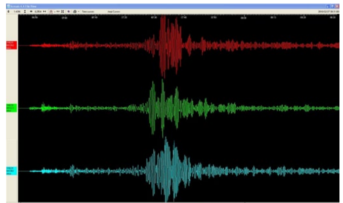
Fig. 10. Sismograma del terremoto de Costa de Maule, Chile, de 27/02/2010, de magnitud 8.8 M_w , registrado en el sismógrafo de banda ancha de la Universidad de Jaén. Las ondas superficiales son las que predominan en el registro. De arriba a abajo: componentes NS, vertical y EW. Ventana de tiempo que se muestra: aprox. 107 min.
