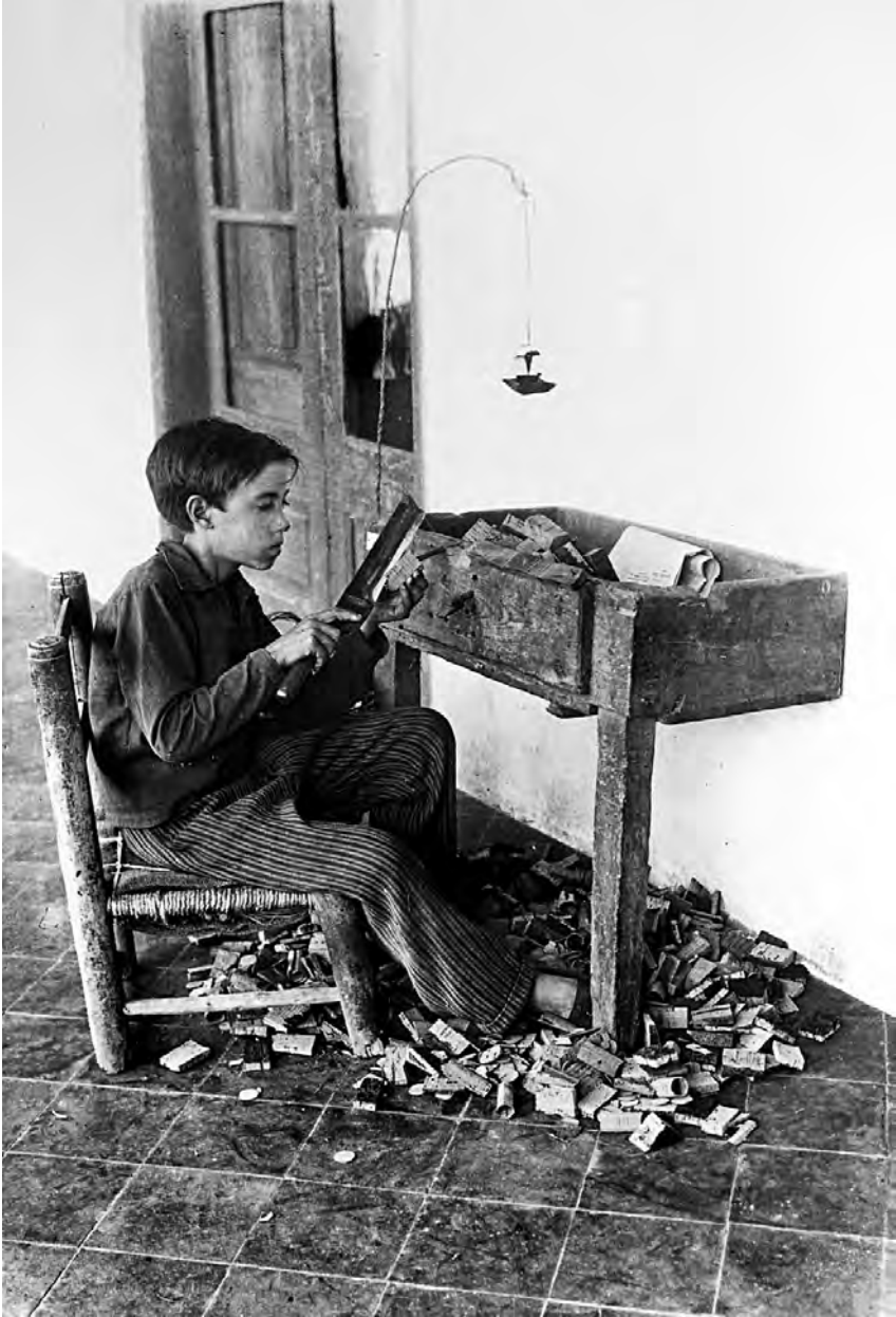
Fig. 6. Els joves aprenents arribaven a fabricar 1.000 taps diaris a cop de ganivet. Fotografia de principis del segle XX, autor desconegut (SAMP).
