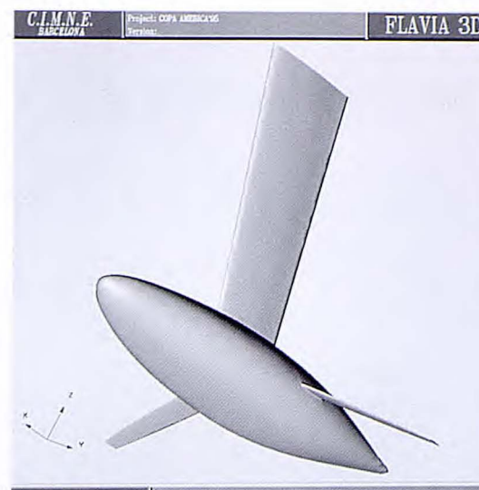
MODÈLE GÉOMÉTRIQUE POUR L'ANALYSE HYDRODYNAMIQUE DE LA QUILLE D'UN VOILIER
